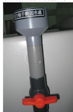
里加水。最好每天上班前和下班前都往压力桶加一次水，以免实验暂停。 **注：在实验过程中往压力桶加水需先将“喷雾”按钮关闭，否则打开红色阀门时此处将喷水，加完水后再打开“喷雾”按钮。**
